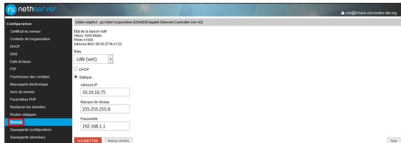
**Configuration | Réseau | onglet Nouvelle interface logique | vis-à-vis la carte ethernet du réseau Externe (LAN rouge) → Éditer.**
